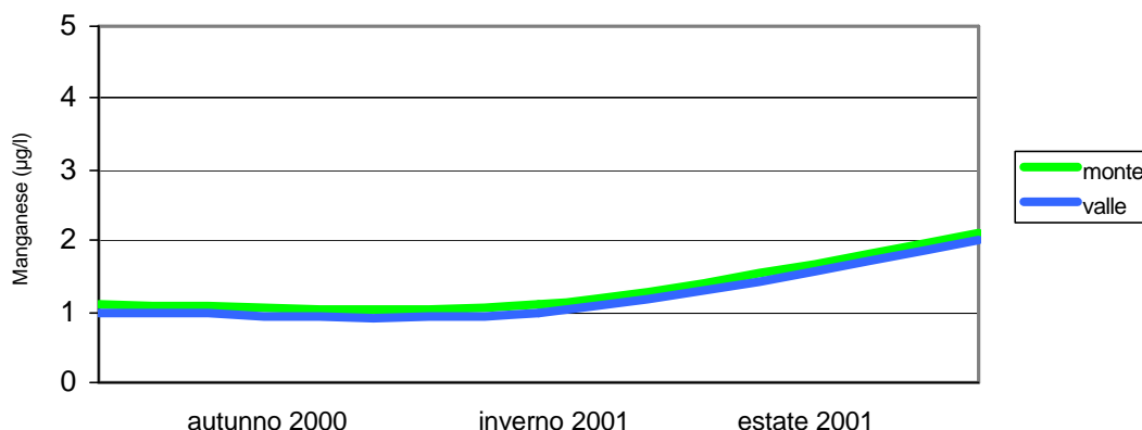
Figura 10.6.6: Confronto tra le concentrazioni di manganese delle acque di falda, misurati in pozzi spia posti a monte ed a valle, rispetto al verso prevalente di scorrimento, presenti presso la discarica per rifiuti speciali inerti CRAVER in comune di San Martino Buon Albergo. (Fonte: Dipartimento Provinciale ARPAV di Verona)
